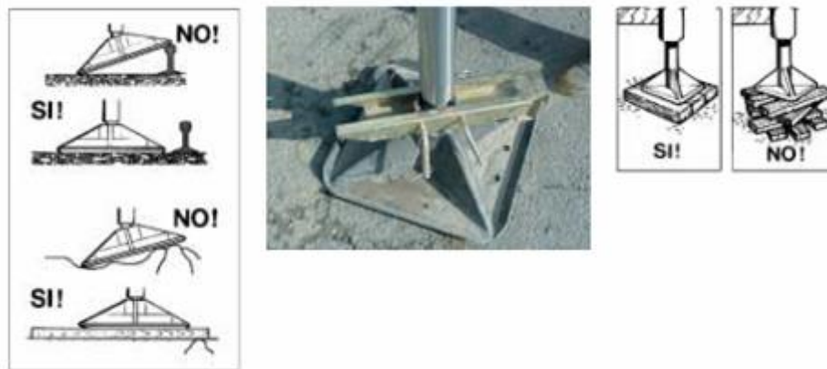
Figura: Forma correcta de disposición de estabilizadores.
